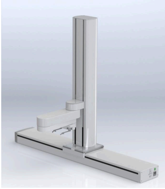
그림 2-2: 1000mm 선형 축 모듈의 750mm 수직 이동 PreciseFlex 3400
